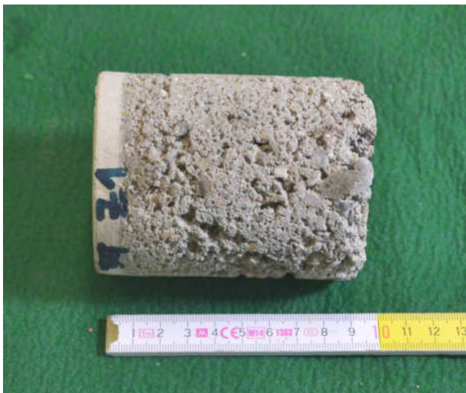
Obr. 4 – Vzorek Z1, podkladní beton v podlaze pod 1.NP
