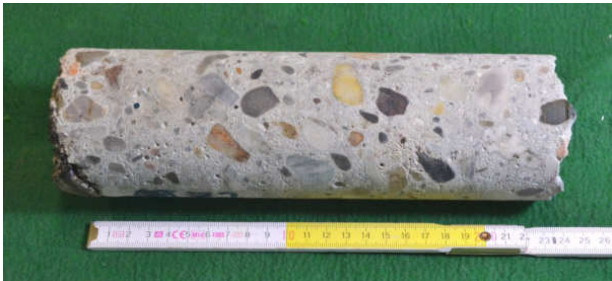
Obr. 5 – Vzorek Z2, beton ze základu
