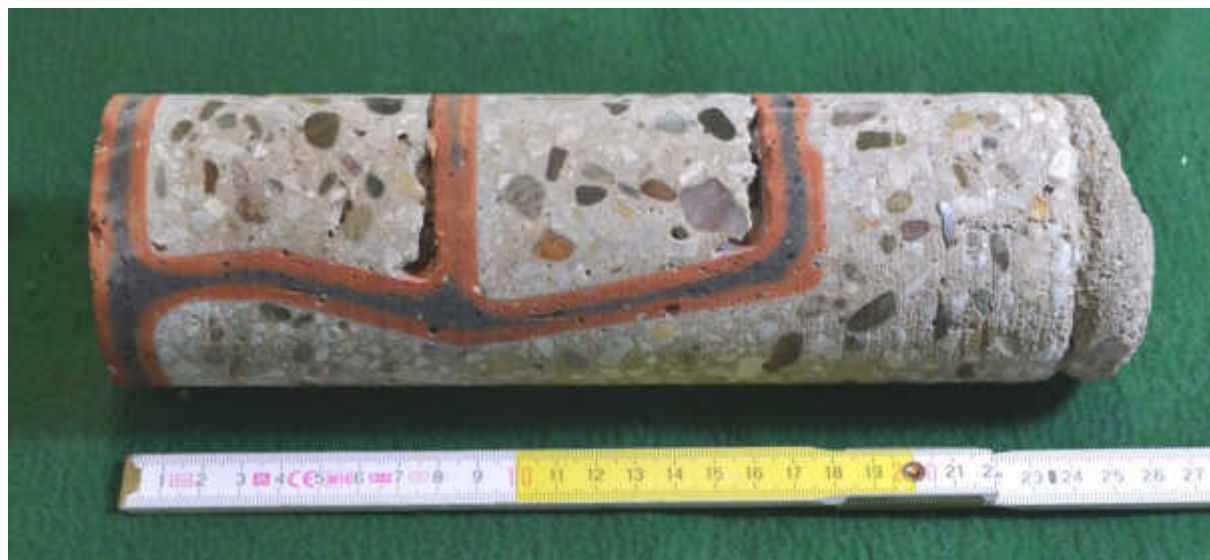
Obr. 9 – Vzorek S3, kompletní průvrt stropní konstrukcí nad 1.NP
