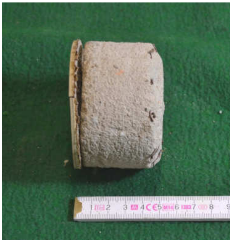
Obr. 11 – Vzorek S4, podlahová konstrukce ve 2.NP (drátkobeton)
