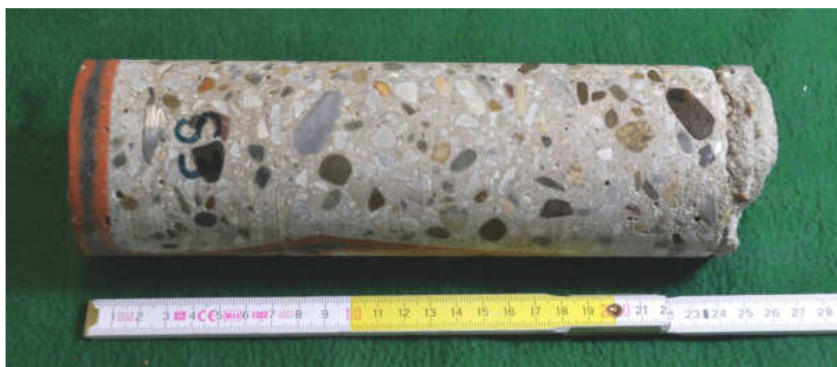
Obr. 8 – Vzorek S3, kompletní průvrt stropní konstrukcí nad 1.NP
